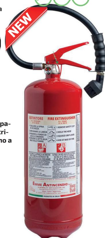
Estintore a base d'acqua con agente estinguente premiscelato realizzato con involucro in acciaio al carbonio con trattamento interno di plastificazione. Ideale per installazione a bordo di automezzi o veicoli adibiti al trasporto di persone.
