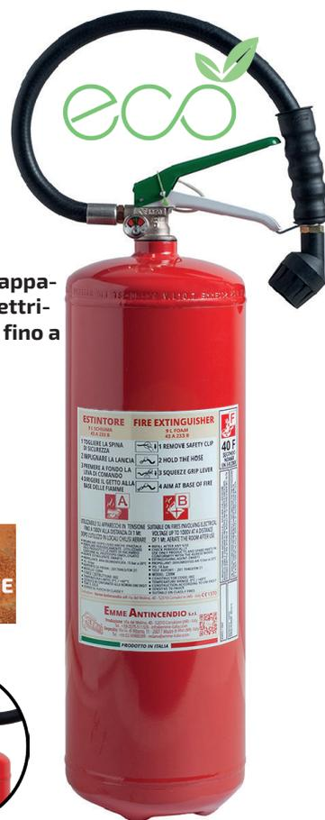
Estintore a base d'acqua con agente estinguente premiscelato realizzato con involucro in acciaio al carbonio con trattamento interno di plastificazione. Realizzato con valvola speciale con corpo in ottone maggiorato e trattamento anticorrosione per prevenire la formazione di corrosione.
