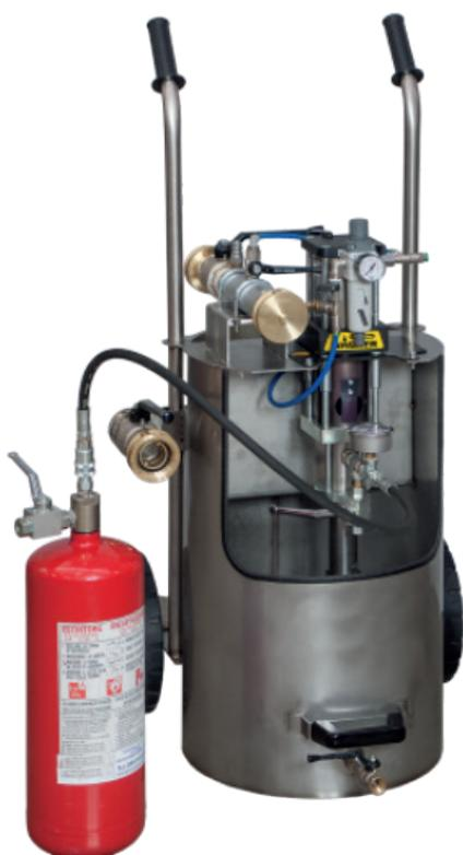
Unità pneumatica multifunzione per il collaudo e l'asciugatura di tubazioni antincendio ed estintori a max 60 bar. Interamente realizzato in acciaio INOX e dotato di due ruote che ne facilitano il trasporto. Alimentazione ad aria 4 bar max, serbatoio scorta acqua lt 25. Dotato di serie di spugna UNI45 per asciugatura, una chiave idrante tipo A, una gabbietta recupero spugna. Dim. 600x600x1000 mm peso 35 kg
