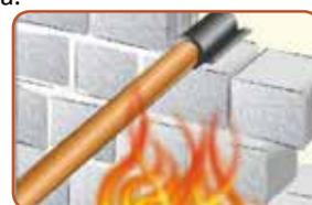
**EI 120 - EN 1366-3 Nastri termoespandenti per tubi combustibili. (PVC, PE, PEHD ecc.) Applicare all'interno della muratura**
