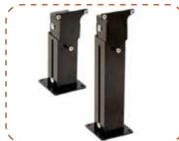
Colonna allungabile a sezione quadra mm. 40 x 40 per il fissaggio orizzontale a parete o verticale a pavimento degli elettromagneti per porte tagliafuoco - Corpo in acciaio verniciato nero. Piastra per il fissaggio dell'elettromagnete orientabile di 180°
