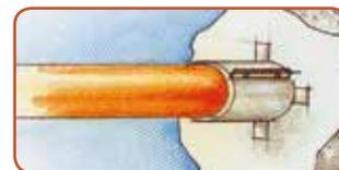
**EI 120 - Collari per tubi combustibili (PVC, PE ecc.) Applicare solo sul lato esposto al fuoco. Se il fuoco è previsto da entrambi i lati applicarne 1 per lato. Su cartongesso REI 120 applicarne 2 per lato uno all'interno e uno all'esterno.**
