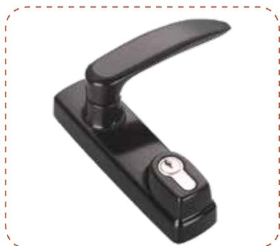
Comando esterno maniglia in folle in zama verniciata e acciaio zincato, manico in alluminio pressofuso verniciato, cilindro europeo con combinazioni diverse, 3 chiavi nichelate, albero quadro in acciaio zincato bianco, 1 vite TCEI M5x30 e 2 viti TS M5x80 in acciaio zincato. Dotato di dispositivo condominio.
