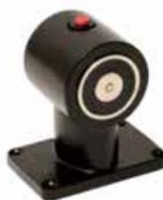
Blocco elettromagnete nichelato. Alimentazione: 24 Vdc - Corrente assorbita: 70 mA. Forza trazione: > 55 Kg. Perno anti-magnetismo residuo sul corpo elettromagnete. Connettore di collegamento a vite con varistore anti-disturbo. Fornito senza contropiastra. Conformità: UNI EN 1155. Impiego: elettromagnete per porte tagliafuoco ad anta
