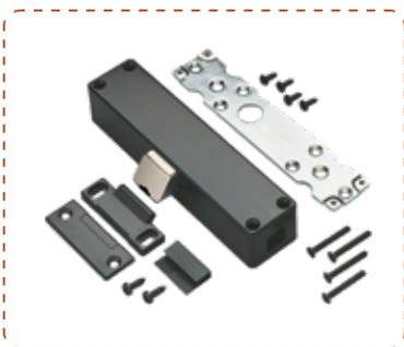
Terzo punto di chiusura, ambidestro, supporto in alluminio verniciato nero, scrocco in zama nichelata e tassello in materiale plastico autolubrificante pre-assemblato, contropiastra di fissaggio in acciaio zincato, 2 ferrogliere in zama verniciata nera, inserto copribattuta in nylon nero, 2 viti TC Ø 4,2x13, 4 viti TS Ø 4,2x13, 4 viti TS M4x30 in acciaio zincato nero.
