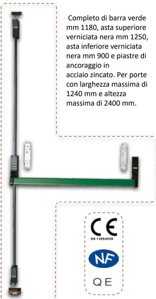
Completo di barra verde mm 1180, asta superiore verniciata nera mm 1250, asta inferiore verniciata nera mm 900 e piastre di ancoraggio in acciaio zincato. Per porte con larghezza massima di 1240 mm e altezza massima di 2400 mm.
